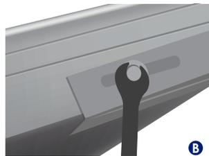
Verifique que los colectores y el estanque de agua estén alineados y colocados uniformemente en el marco(A), y APRIETE TODOS LOS PERNOS (B)
