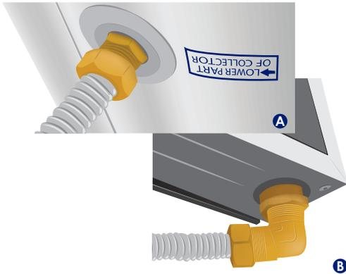
Repita el procedimiento para la tubería de acero inoxidable flexible corrugada de la salida inferior del colector a la salida en el lado inferior del estanque marcada en consecuencia (A y B).
